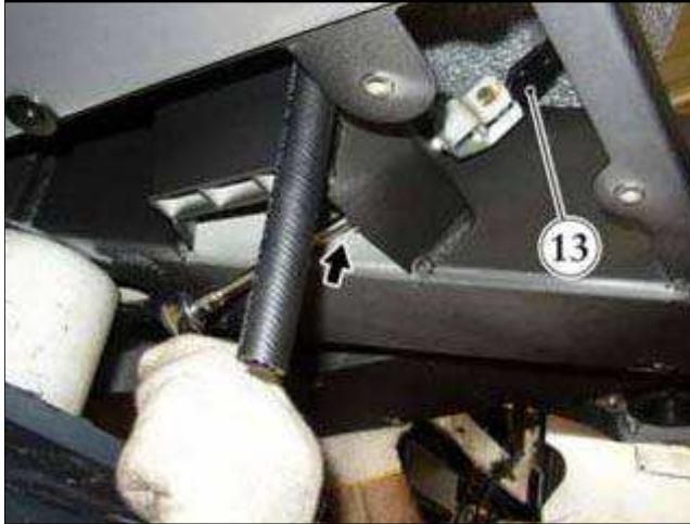
● 手动拧紧紧固油箱固定带 (13) 的下部螺母。
