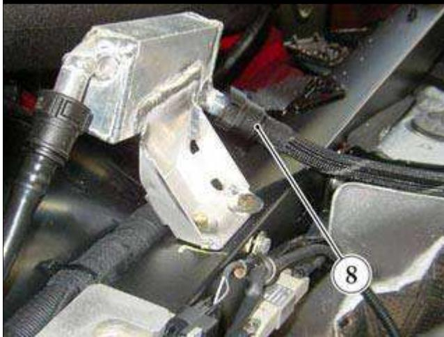
● 从燃油蒸汽分离器拆下通向多功能阀的管 (8), 或在右侧油箱情况下, 拆下通向滚翻切断阀的管。
