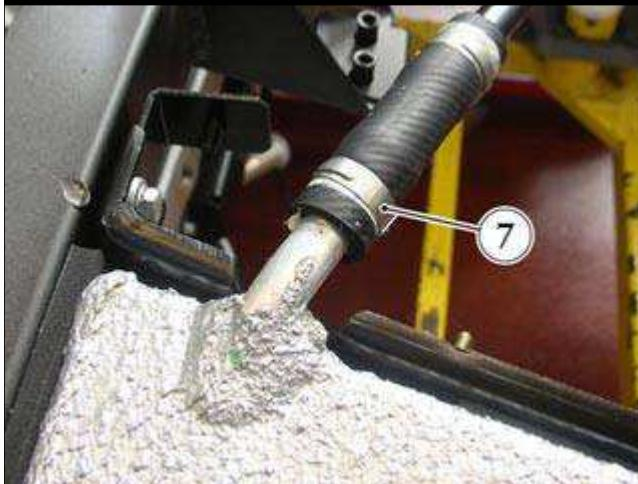
● 打开夹子 (7), 分离油箱上部连接管。
