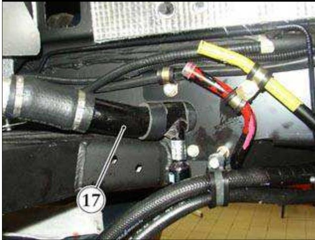
● 在拆卸油箱防护罩之后，可以更换在下部连接油箱的管(17)。
