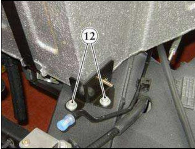
通过松开两个螺钉 **(12)** 拆卸油箱上的下部支架。
