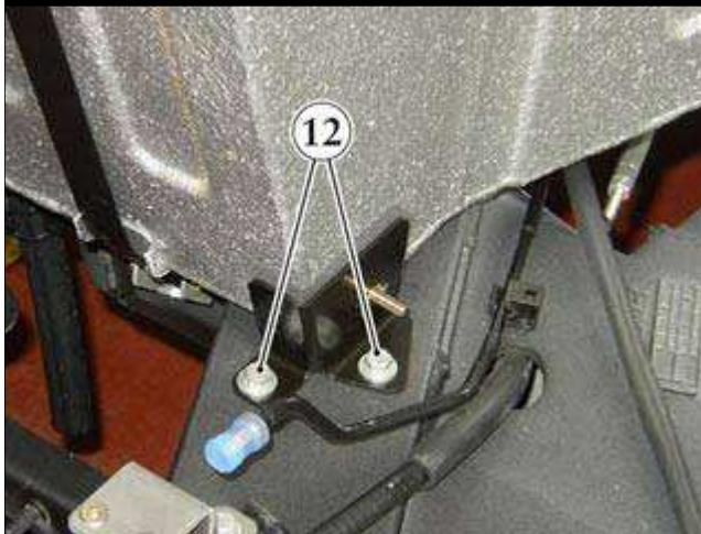
● 安装下部油箱支架并通过手动拧紧两个螺钉 (12) 紧固。
