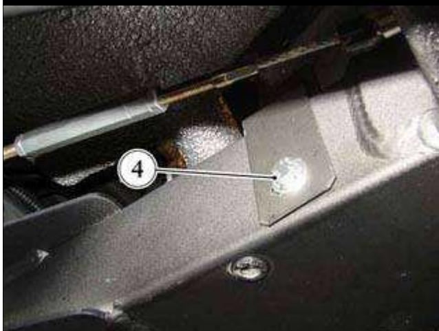
● 松开将隔热罩紧固到底座的螺钉 (4)。
