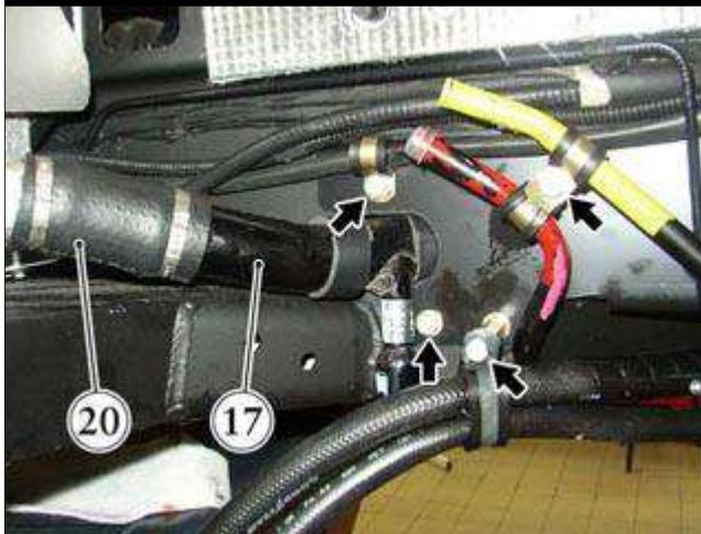
● 拆卸也将底板管支架固定到遮盖车架下部横梁上管防护装置的紧固螺钉和双头螺栓。
